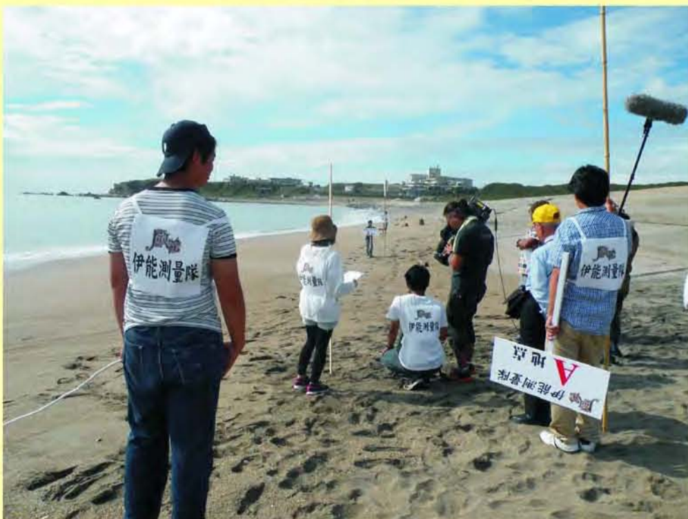
君ヶ浜海岸：梵天を立て方位を測り間縄と間竿で距離を測ります
